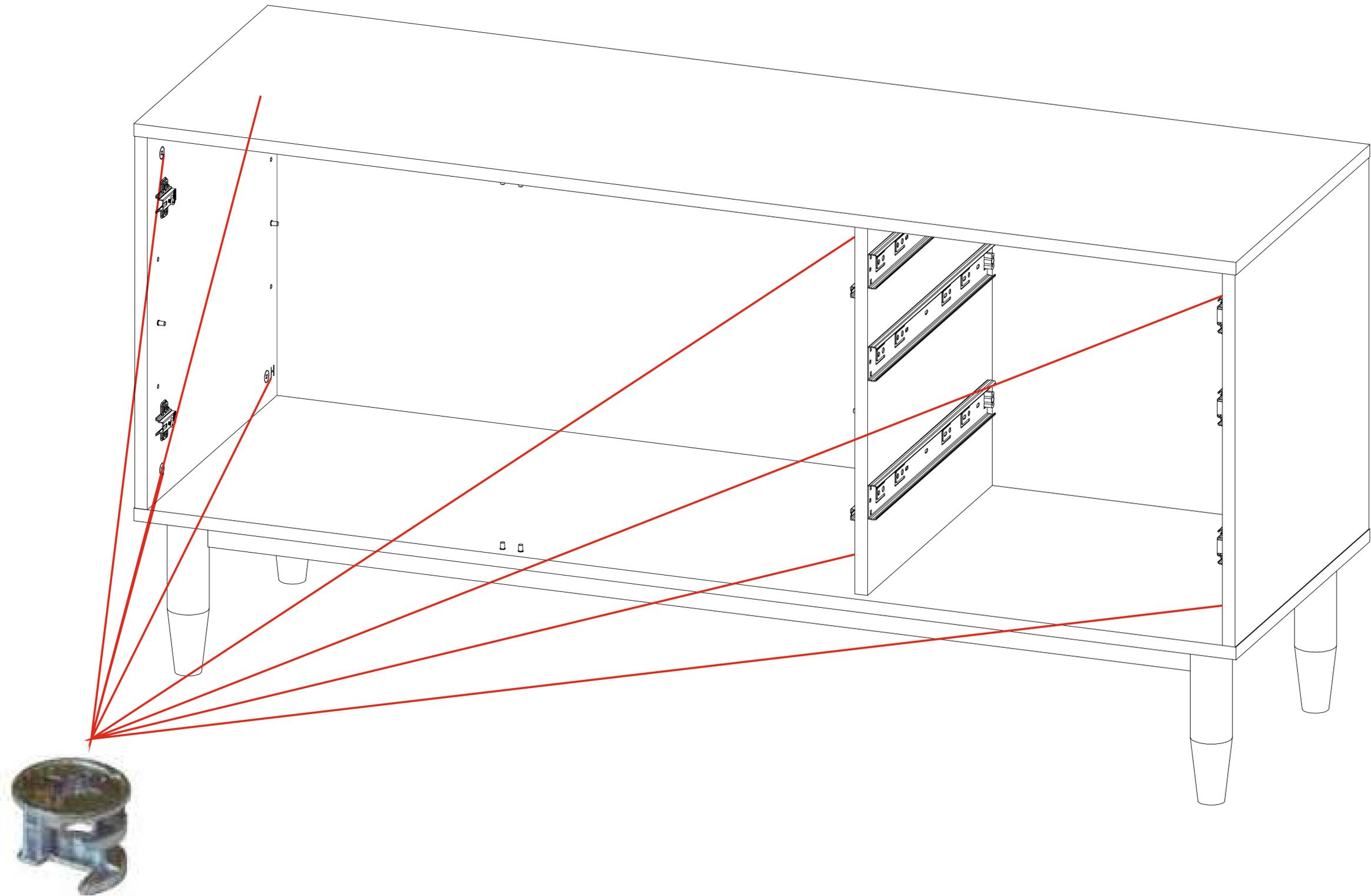
При соединении корпуса необходимо повернуть бочонок эксцентрика для стяжки компонентов
