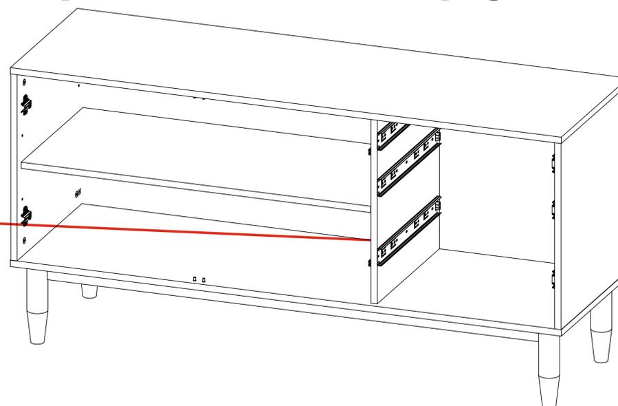
! Обязательно соблюдайте последовательность сборки в инструкции. Верхняя крышка корпуса устанавливается после монтажа задней стенки.
