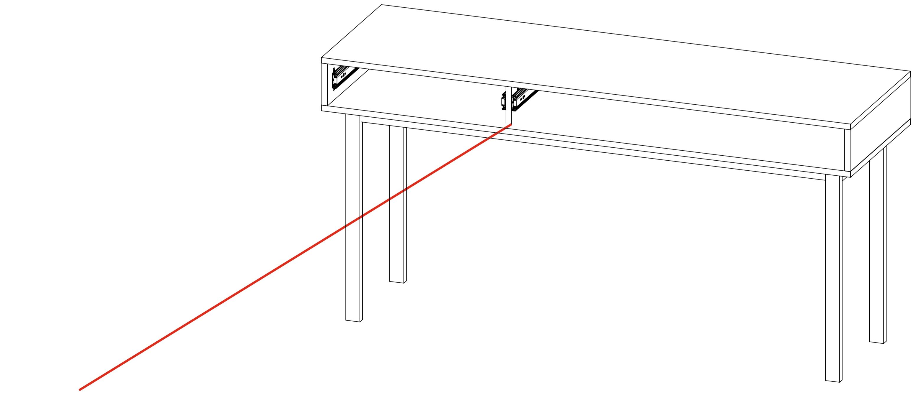
На центральных частях корпуса **направляющие** устанавливаются **с обеих сторон детали**
