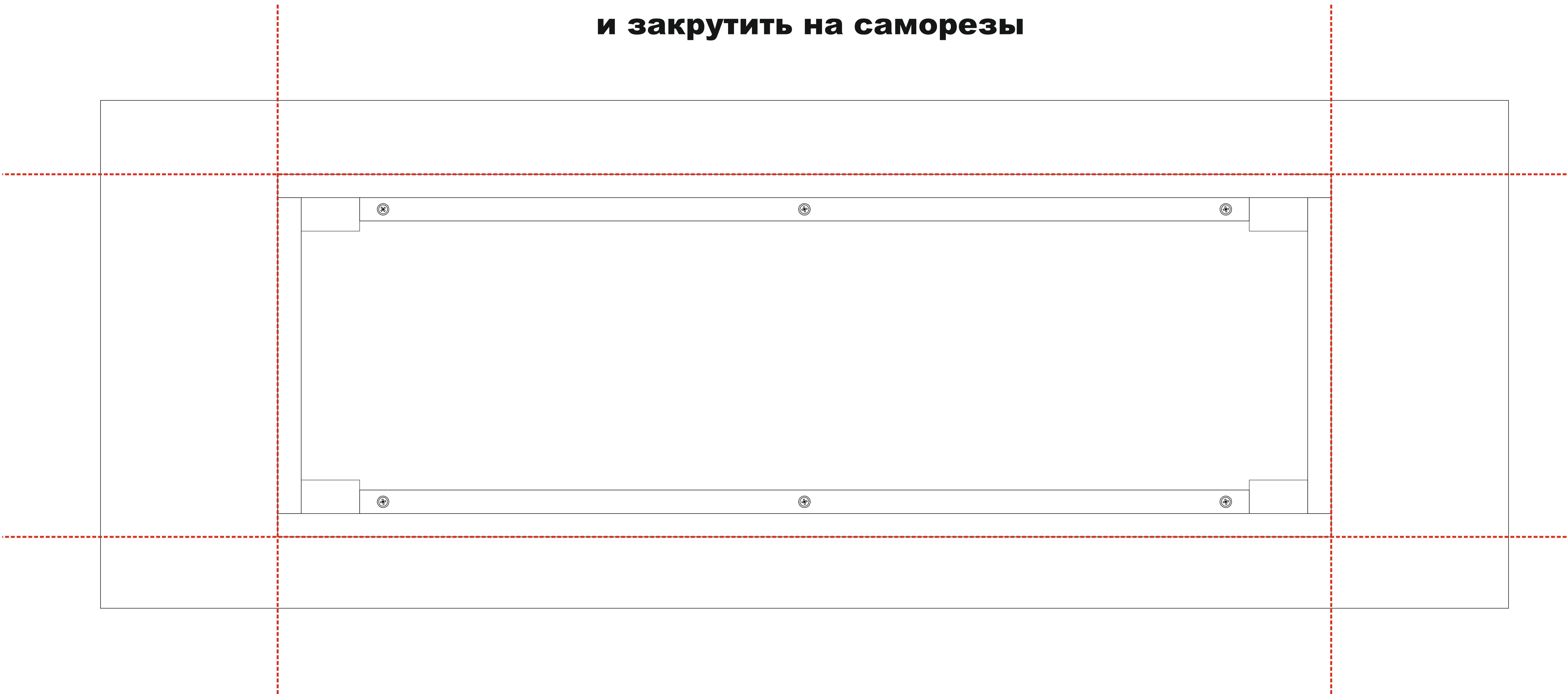
**Используйте саморезы из комплекта для фиксации каркаса ног
