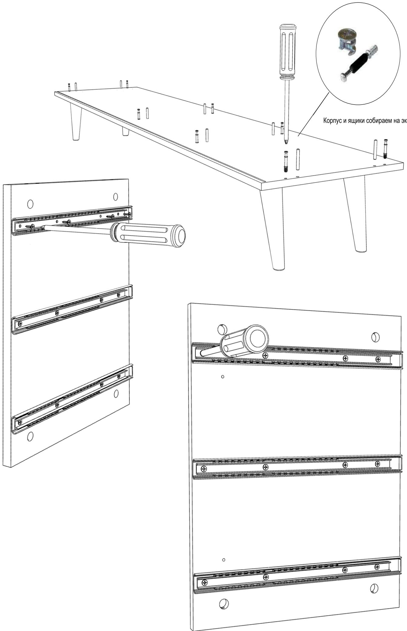
Корпус и ящики собираем на эксцентриковые стяжки
